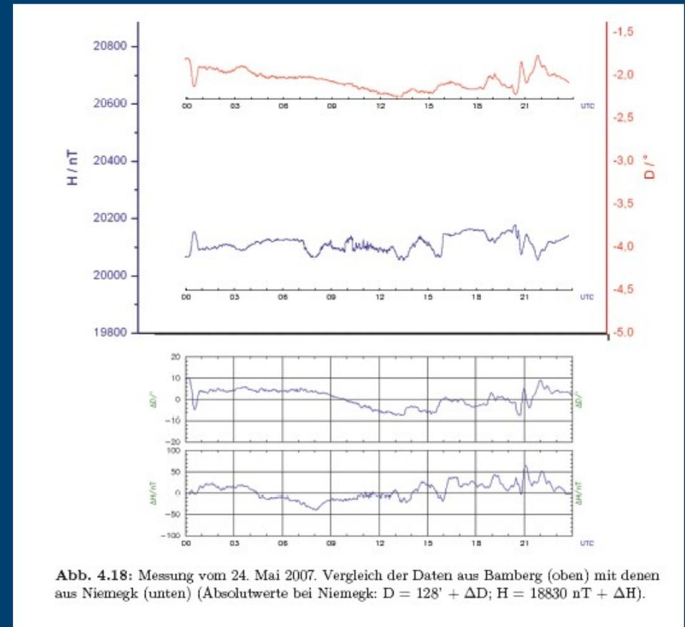
Abb. 4.18: Messung vom 24. Mai 2007. Vergleich der Daten aus Bamberg (oben) mit denen aus Niemeck (unten) (Absolutwerte bei Niemeck:  $D = 128^\circ + \Delta D$ ;  $H = 18830 \text{ nT} + \Delta H$ ).
