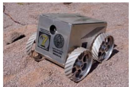
Der im Auftrag der ESA entwickelte Würzburger Mars-Rover MIDD
