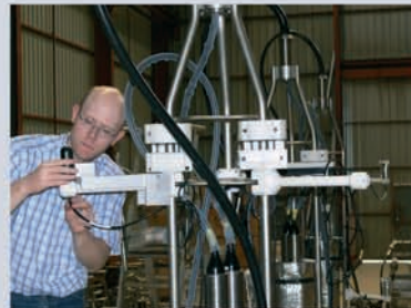
Ein Mitarbeiter des ECAP bei Montagearbeiten an einem ANTARES-String.
