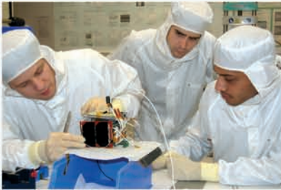
Internationales Studententeam bei der Integration des UWE-2 im Reinraum
