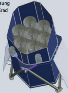
Technische Zeichnung des unter Mitwirkung der Reemis-Sternwarte unter Federführung des Max-Planck-Instituts für extraterrestrische Physik entwickelten eROSITA-Experiments, das 2012 auf dem russischen Satelliten Spectrum-X-Gamma gestartet werden soll. (Quelle: MPE)
