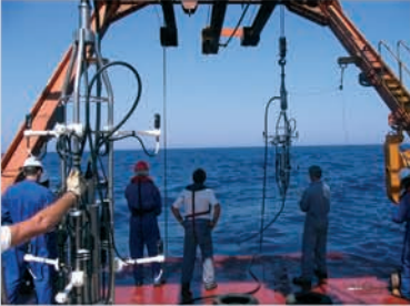
Ein ANTARES-String wird vom Schiff aus ins Meer hinuntergelassen.
