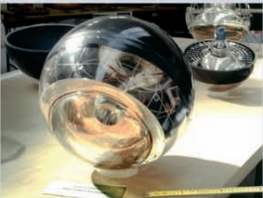
Eine Glaskugel mit dem darin befindlichen Photosensor. Die Kugel muss einem Druck von ca. 250 bar standhalten, der in der Meerestiefe von 2500 Metern herrscht.
